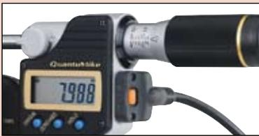
La función de salida de datos es disponible con el cable de conexión resistente al agua.
