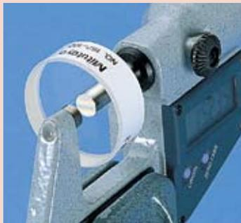
La Planitud de las Superficies de Medición se Inspeccionan Usando un Patrón de Franjas de Interferencia, Producido por un Plano Óptico.
