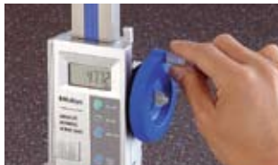
Suave deslizamiento del cursor con una manivela
