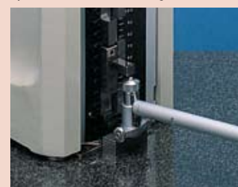
Fijado del cero en un Bore Gage
