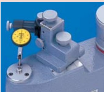
Calibrando un indicador de carátula tipo palanca
