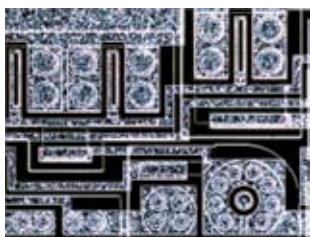
Observación con campo obscuro (DF): Observando sólo la luz dispersa apagando la luz directa a los objetivos. Las rayaduras y polvo que no pueden ser vistas con campo se pueden observar mediante un alto contraste.
