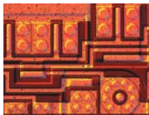
Observación con contraste de interferencia diferencial (DIC): Efectiva para detectar pequeñas rayaduras y escalones sobre la superficie de metal, cristal líquido y semiconductores.
