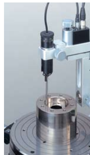
Medición dentro de diámetro interior
